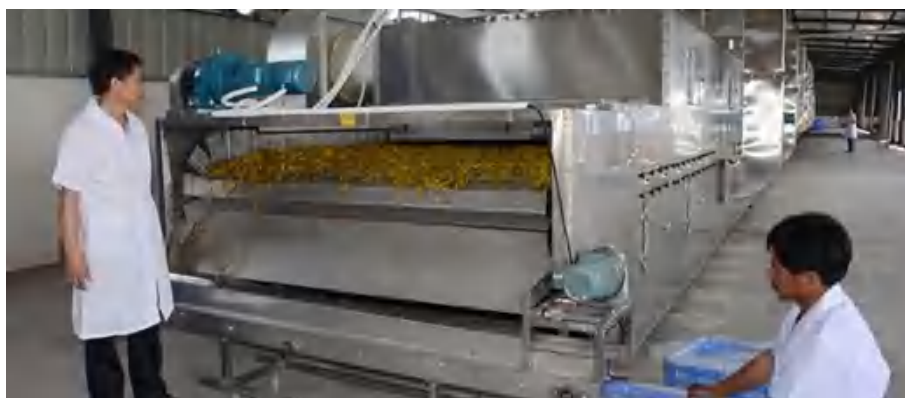
图 3-3 黄花菜机械生产线焖蒸杀青烘干设备
